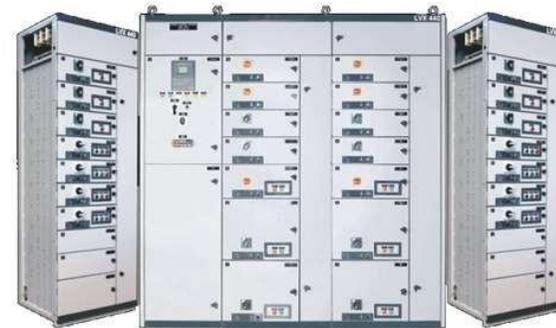
CCM de BT-TTA, atendendo à norma NBR IEC 60439-1. Corrente de curto circuito 65KA, tensão de operação 480V. Grau de proteção IP-40 a IP-54. Pintura Epóxi eletrostática interna/externa, nas cores padrão do cliente. Construção em gavetas fixas ou extraíveis. Tipo convencional ou inteligente.
